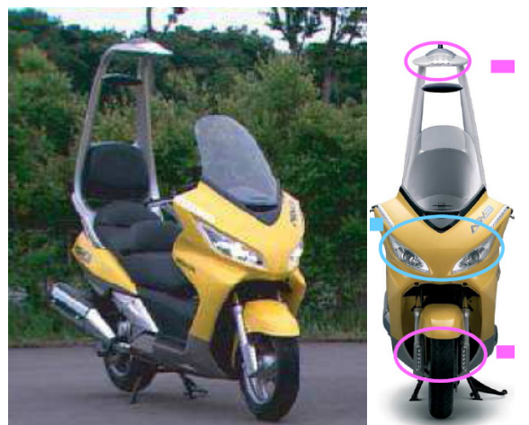
Abbildung 14 Lichttechnische Massnahmen zur Verbesserung der Sichtbarkeit
