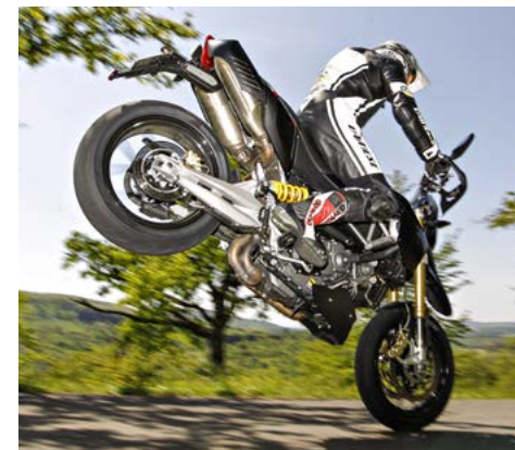
Sensoren an beiden Rädern überwachen beim Bremsen wie beim Beschleunigen, dass sich beide Räder drehen und auch beide am Boden bleiben. Falls nicht, werden Bremsdruck oder Leistung reduziert
