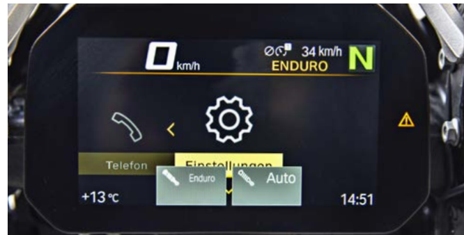
Motormappings, ABS und Fahrwerk lassen sich über Fahrmodi programmieren; hier steht alles im Modus „Enduro“, die Federung auf Automatik
