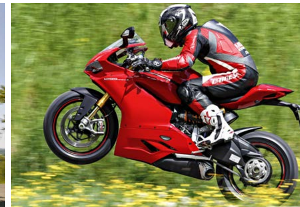
Sensoren an beiden Rädern überwachen beim Bremsen wie beim Beschleunigen, dass sich beide Räder drehen und auch beide am Boden bleiben. Falls nicht, werden Bremsdruck oder Leistung reduziert
