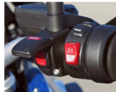
E-Call, das automatische Notrufsystem, ab 2018 Pflicht für neue Autos, gibt es für Motorräder von digades (links) und ab Werk von BMW (rechts)
