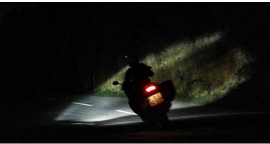
Das Kurvenlicht wird über Schräglagensensoren gesteuert und kompensiert die reduzierte Lichtausbeute des schräg stehenden Scheinwerfers (linkes Bild), der Lichtkegel leuchtet die Kurve besser aus (rechtes Bild)
