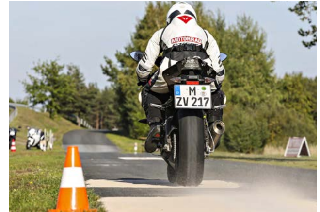
Die Traktionskontrolle reduziert den Vortrieb bei mangelndem Grip und verhindert so ungewolltes, seitliches Ausbrechen des Hinterrads
