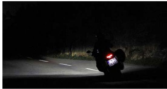
Das Kurvenlicht wird über Schräglagensensoren gesteuert und kompensiert die reduzierte Lichtausbeute des schräg stehenden Scheinwerfers (linkes Bild), der Lichtkegel leuchtet die Kurve besser aus (rechtes Bild)
