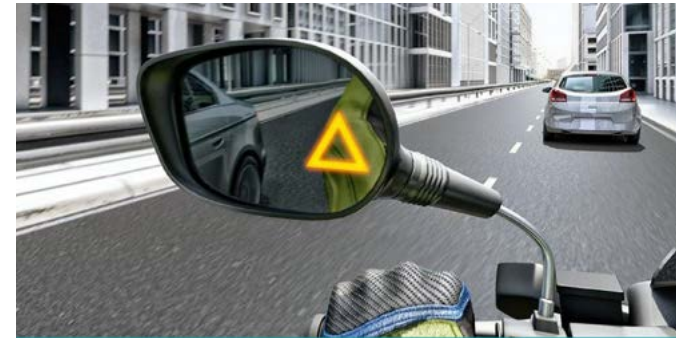
Der „Tote-Winkel Assistent“ blinkt mit einem Dreieck, wenn sich Fahrzeuge im toten Winkel des Spiegels befinden.
