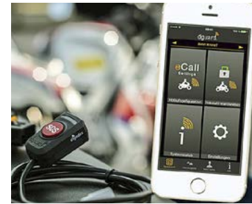
E-Call, das automatische Notrufsystem, ab 2018 Pflicht für neue Autos, gibt es für Motorräder von digades (links) und ab Werk von BMW (rechts)
